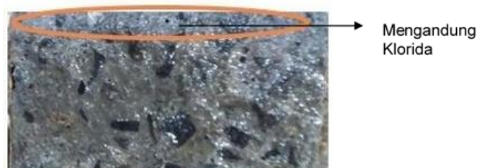
Gambar 2. Pengujian Penetrasi Klorida pada Beton
