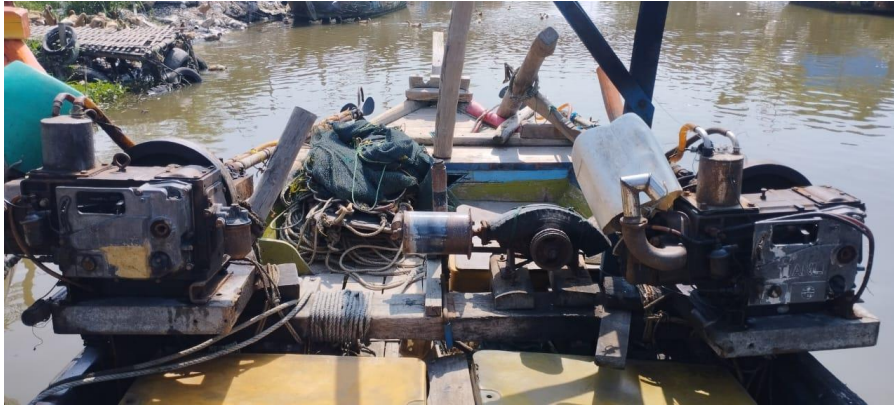
Gambar 2 Mesin kapal pukat hela dasar
