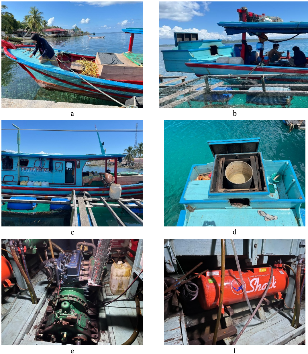
Gambar 3 (a) Haluan kapal; (b) Buritan kapal; (c) Anjungan kapal; (d) Tempat perebusan kapal; (e) Mesin induk kapal; (f) Mesin kompresor
