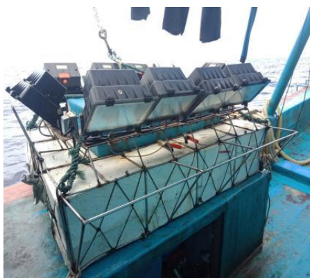
Gambar 7. (a) Lampu rakit; (b) Desain lampu rakit
