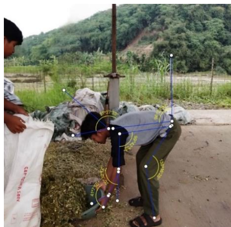
Gambar 8 Proses memasukkan hijauan secara manual pada mesin chopper sebelum modifikasi
