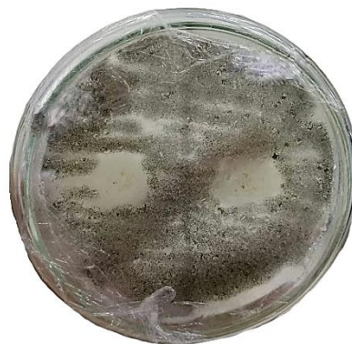
Gambar 3. Zona hambat yang terbentuk dalam pengujian aktivitas antikapang terhadap Aspergillus niger sp. pada edible film whey protein dengan penambahan bubuk jahe (2%)
