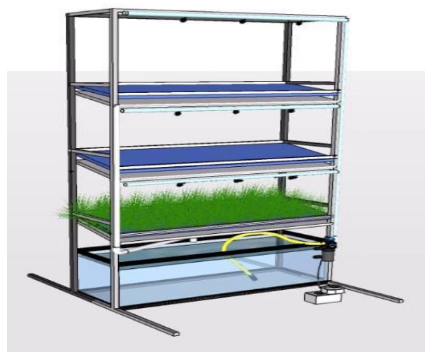
Gambar 5 Desain instalasi aquafodder .
