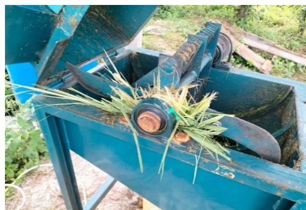
Gambar 9 Lilitan daun dari bonggol tebu pada poros chopper listrik bertenaga surya.
