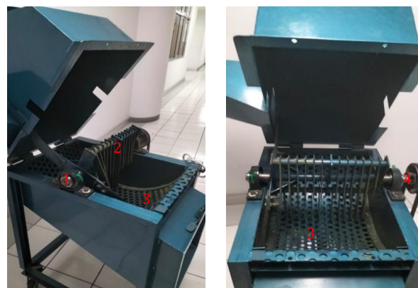
Keterangan: 1 = Pisau pencacah dan pemegang; 2= Pelat pengaduk; 3 = Jaring-jaring (saringan); 4 = Pulleys-V belt
