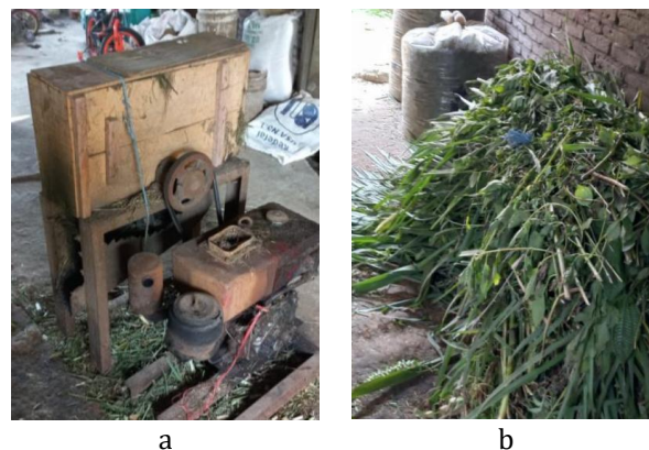
Gambar 1 a) Mesin pencacah pakan ternak sederhana berteknologi konservatif dan b) Pakan ternak untuk ternak sapi dan kambing.
