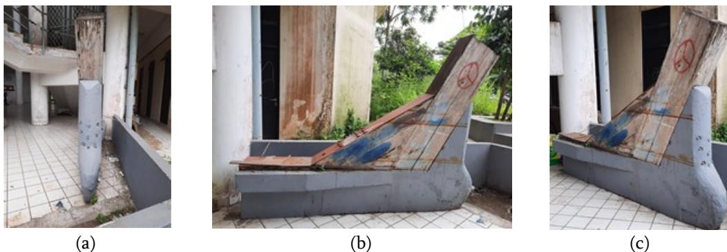
Gambar 7 Hasil pelaksanaan metode struktur kapal beton-kayu pada bagian lunas-linggi depan (a) tampak depan; (b) tampak samping (c) tampak perspektif samping
