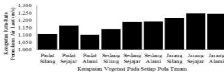
Gambar 3 Grafik kecepatan rata-rata permukaan air laut pada berbagai kerapatan dan pola tanam vegetasi
