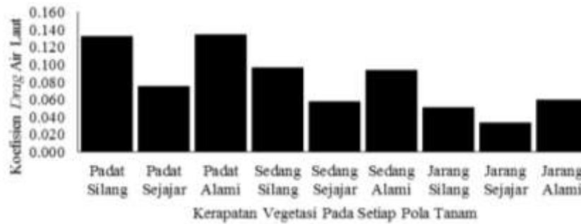
Gambar 5 Grafik koefisien seret air laut pada berbagai kerapatan dan pola tanam vegetasi
