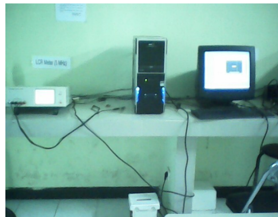
Gambar 1. Rangkaian alat pengukuran nilai dielektrik
