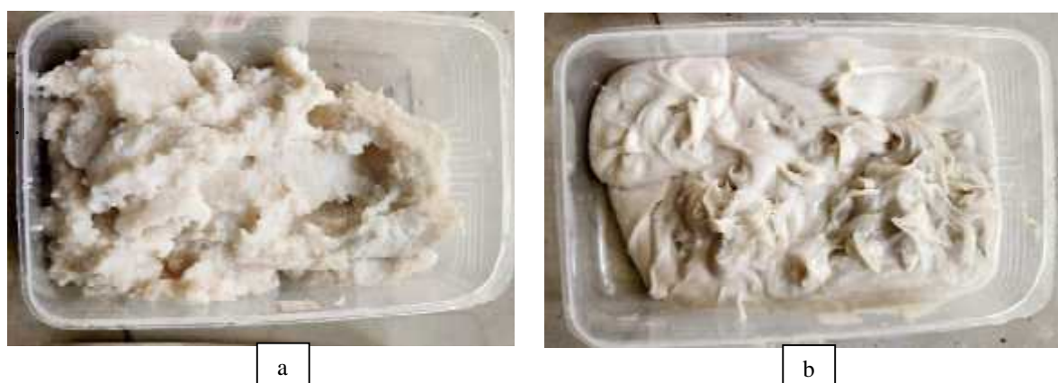
Gambar 2. Tampilan visual biogrease dengan rasio base oil dan thickening agent a. 85 :15; b. 80 : 20
