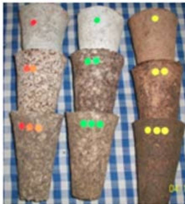
Gambar 2. Produk pot organik dengan bahan dasar organik dengan perekat tanin dan tapioka (merah = tanpa perekat; hijau = perekat kanji; kuning = perekat tanin; lingkaran 1 = kertas koran 100%; lingkaran 2 = kertas koran + serasah 50:50 (v/v); lingkaran 3 = kertas koran + kompos (50:50 v/v)
