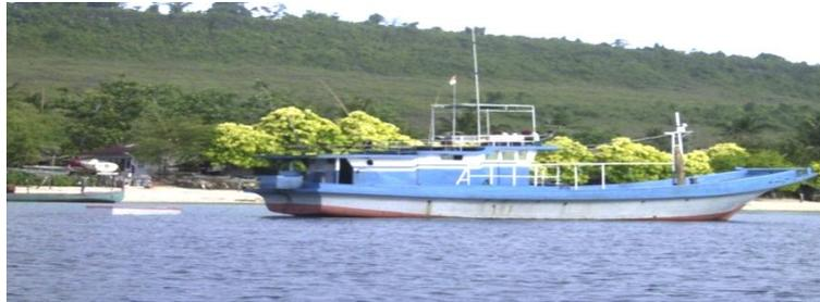
Gambar 4. Kapal huhate dengan sistem motor dalam (motor ikan)
