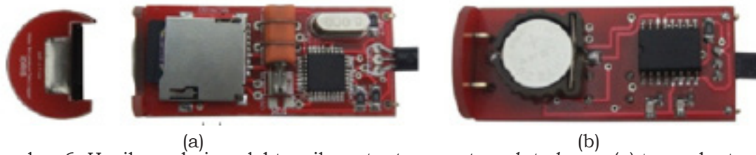
Gambar 6. Hasil rangkaian elektronik water temperature data logger (a) tampak atas (b) tampak bawah
