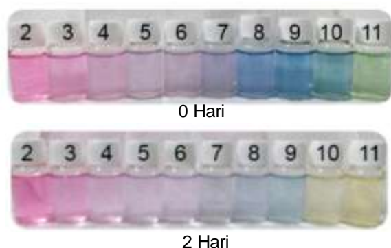
Gambar 1. Kenampakan enkapsulat pigmen kubis merah dalam buffer McIlvaine pH 2-11 (konsentrasi 0,1%) pada penyimpanan suhu 20°C, kondisi gelap
