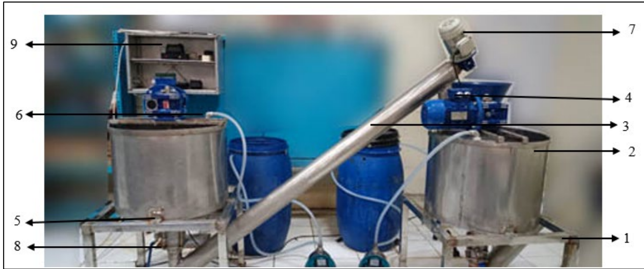
Gambar 3. Mesin Pencuci garam skala kecil
