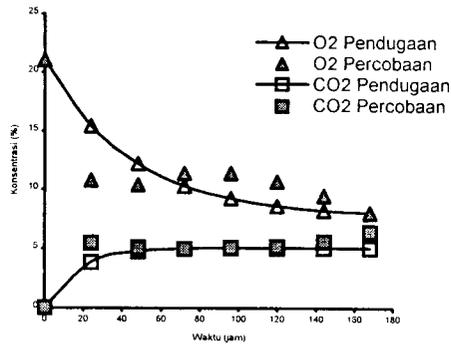
Gambar 5. Grafik pendugaan O<sub>2</sub> dan CO<sub>2</sub> pada pengemasan Wortel suhu 5<sup>0</sup>C, berat 0.5 kg, luas stretch film 0.019 m<sup>2</sup>, dengan wadah kaca, volume bebas 500 ml.
