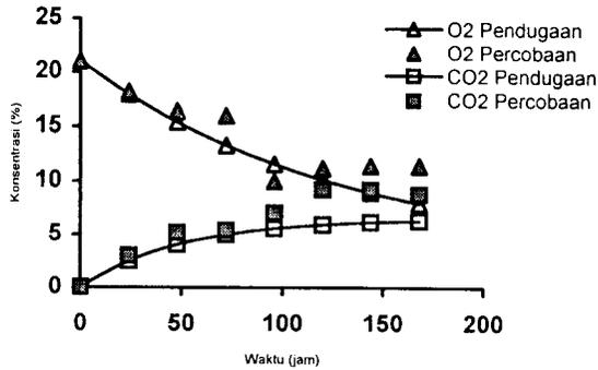
Gambar 6. Grafik pendugaan O<sub>2</sub> dan CO<sub>2</sub> pada pengemasan Cabe Merah suhu 10<sup>0</sup>C, luasan stretch film 0.0092 m<sup>2</sup>, dengan wadah acrylic, volume bebas 713.6 ml.
