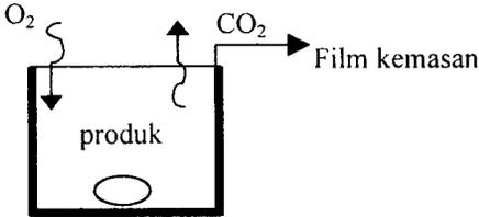
Gambar 1. Model pertukaran gas pada film kemasan
