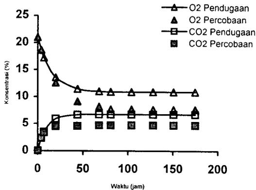
Gambar 7. Grafik pendugaan O<sub>2</sub> dan CO<sub>2</sub> pada pengemasan Tomat suhu 15<sup>0</sup>C, luas stretch film 0.0358 m<sup>2</sup>, dengan wadah polystyrene volume bebas 404 ml.
