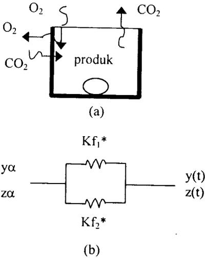
Gambar 2. Model pertukaran gas dari dan ke dalam kemasan
