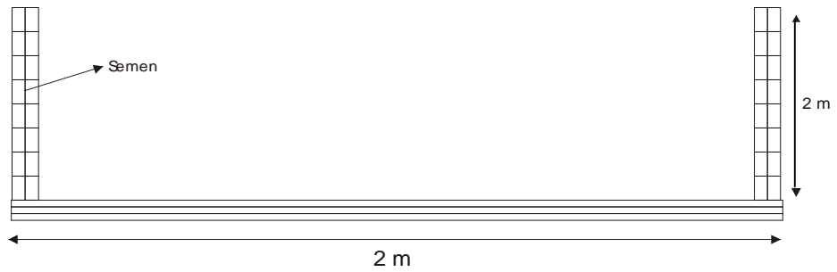
Gambar 3. Penampang Melintang Embung Tipe Permanen
