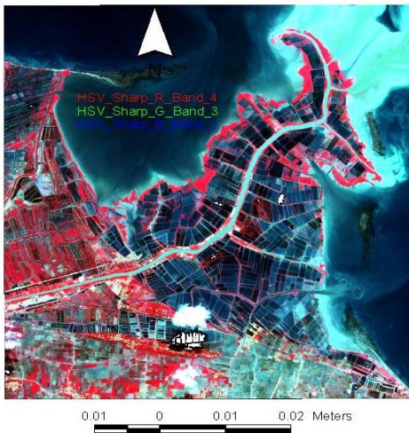
Gambar 4. Fusi Citra Quick Bird dengan Teknik HSV (Hue Saturation Value)
