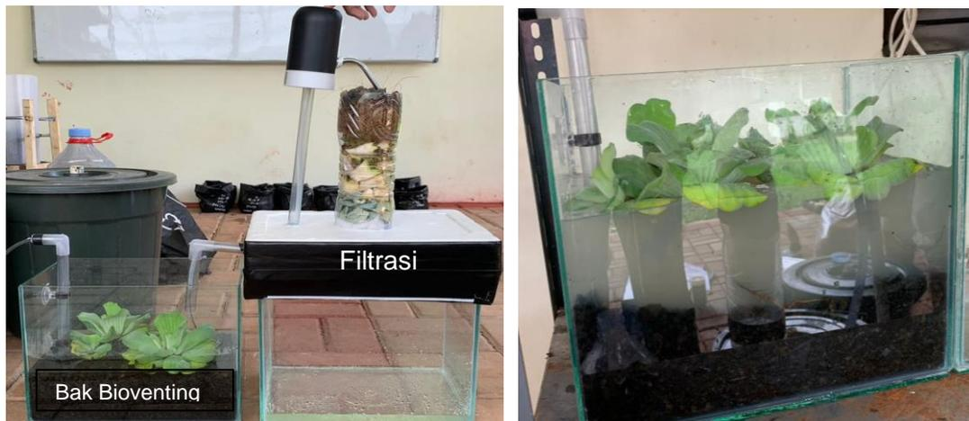
Gambar 2. Alat Pengolahan Limbah *Bioventing* Filtrasi Sederhana
