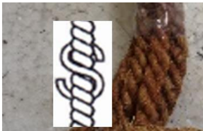
Gambar 3 Arah pilinan tali sabut kelapa
