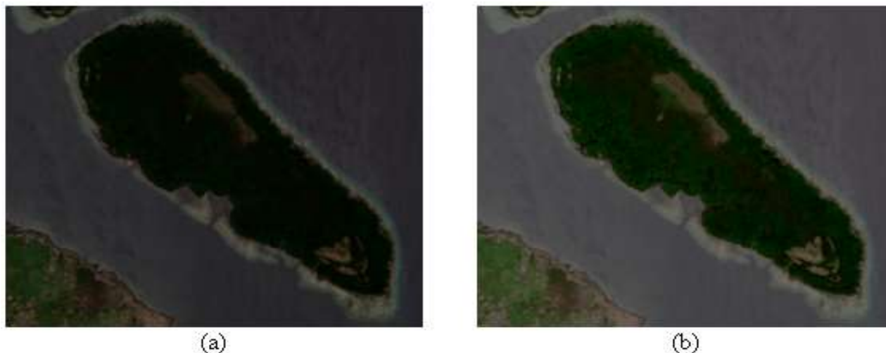
Gambar 5 Koreksi atmosferik citra Sentinel-2 (a) citra sebelum dikoreksi, (b) citra setelah dikoreksi.
