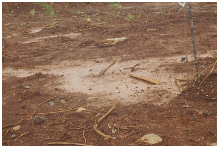
Gambar 2 Lapisan tipis tanah kedap air di daerah cekungan
