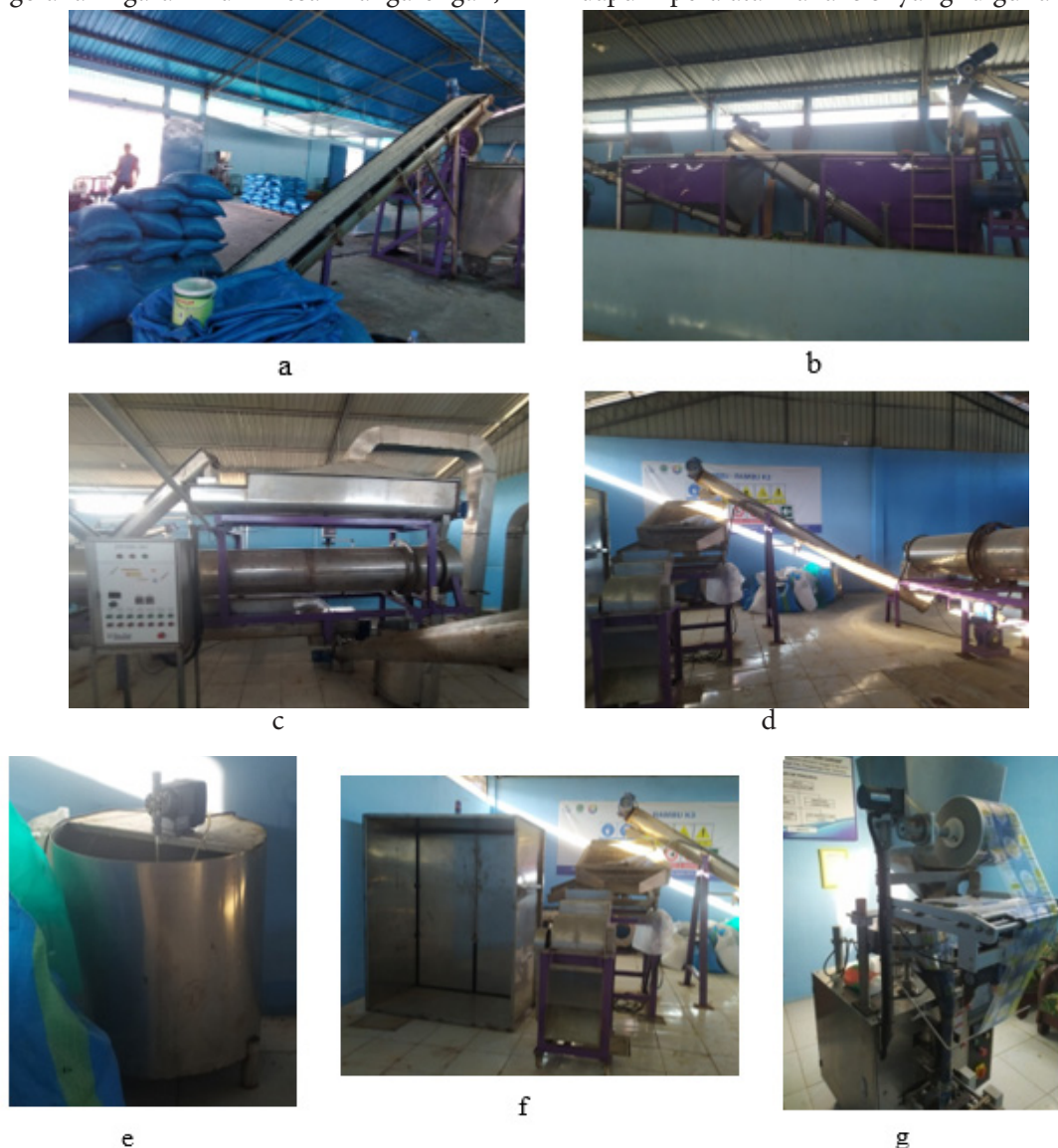
Gambar 1 Unit washing plant dengan beberapa komponennya (a) belt conveyor ; (b) disk milling dan mesin pencucian; (c) penirisan dan mesin pengering; (d) mesin pengering; (e) mesin iodasi; (f) mesin pengayakan dan silo/penampungan; (g) mesin packing
