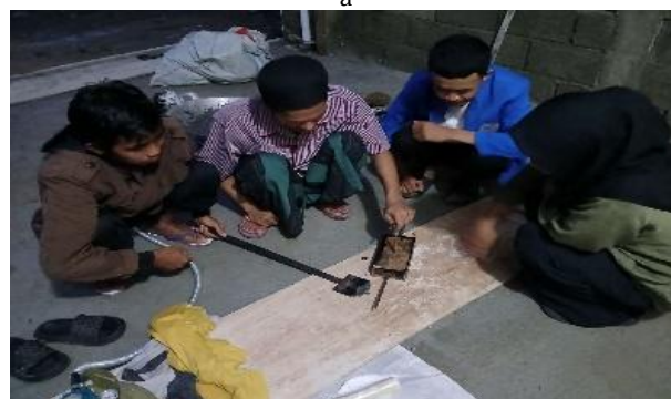
Gambar 4 a) Proses pembakaran sampah plastik dan b) Proses pencetakan batako press.
