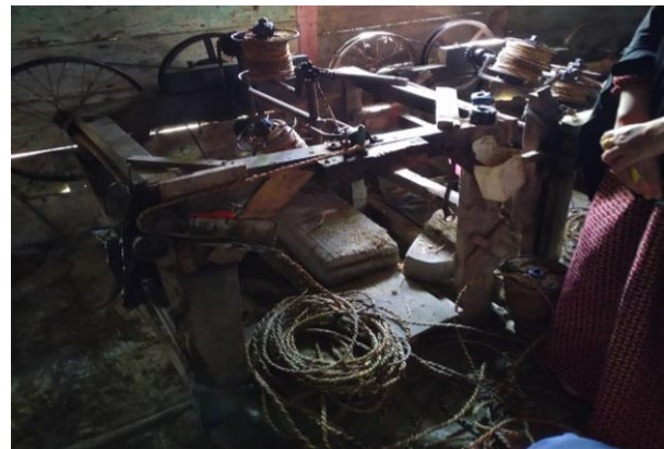
Gambar 2 Alat pintal sederhana.
