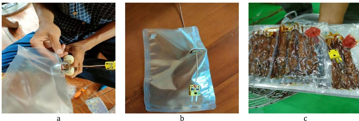
Gambar 3 a) Pemasangan sensor suhu pada kemasan, b) Pemasangan sensor suhu pada sate, dan c) Produk siap diukur kecukupan panasnya.
