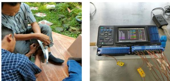
Gambar 2 a) Pemasangan termometer pada tutup presto dan b) *Thermorecorder*.
