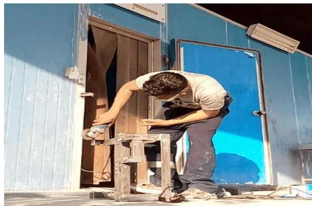
Gambar 2 Proses pembuatan mesin peniris minyak.
