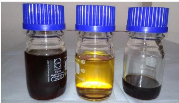
Gambar 9 Produk biodiesel yang dihasilkan: a) Jelantah; b) Biodiesel; dan c) Gliserol.
