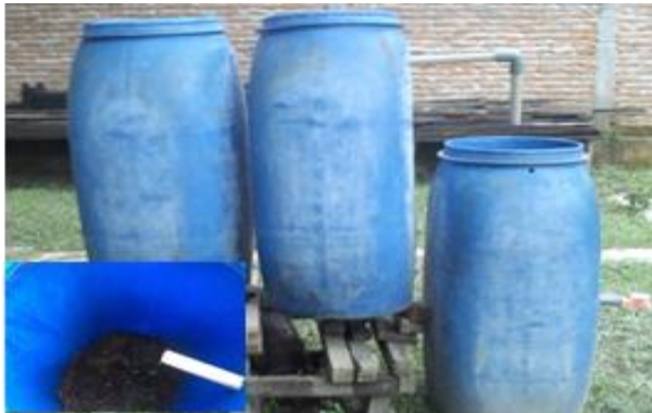
Gambar 5 Aplikasi karbon aktif tempurung kelapa pada gravity-fed filtering system .
