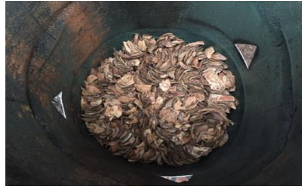
Gambar 4 Praktik pembuatan karbon aktif dari tempurung kelapa.
