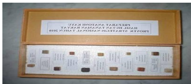
Gambar 2. Preparat kayu hasil HTR bahan observasi sifat mikroskopik
