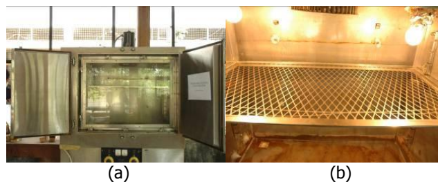
Gambar 2. Ruang fumigasi (a), bagian dalam ruang fumigasi (b)
