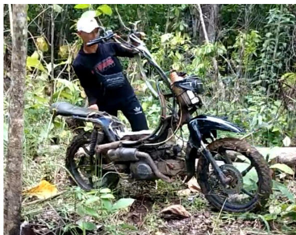
Gambar 1 Sepeda motor dengan modifikasi ekstrem yang digunakan sebagai moda pengangkutan log
