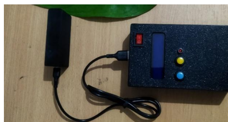
Gambar 5 Klorofil Meter berbasis ESP32
