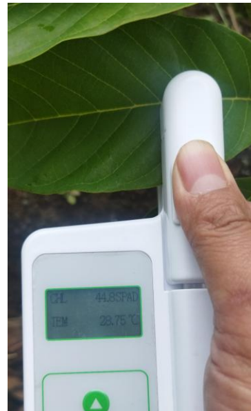
Gambar 11 Pengukuran indeks klorofil menggunakan klorofil meter TYS-A pada daun srikaya jumbo yang berwarna hijau tua (SPAD : 44.8)
