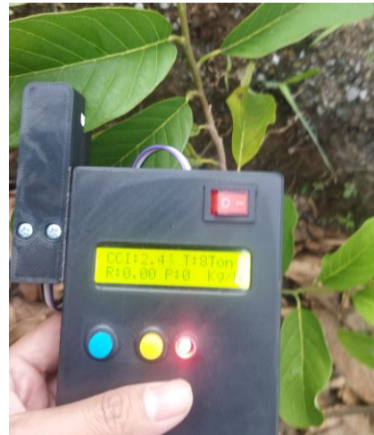
Gambar 9 Pengukuran indeks klorofil menggunakan klorofil meter berbasis ESP32 pada daun srikaya jumbo yang berwarna hijau tua (CCI : 2.40)
