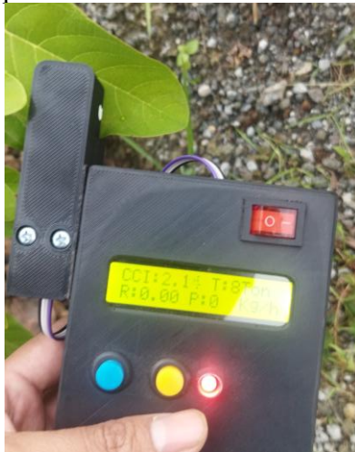
Gambar 8 Pengukuran indeks klorofil menggunakan klorofil meter berbasis ESP32 pada daun srikaya jumbo yang berwarna hijau muda (CCI : 2.10)
