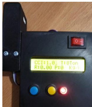
Gambar 7 Nilai CCI=1.00 saat kondisi tidak ada daun pada sensor TSL2561
