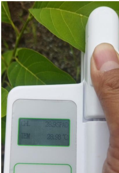
Gambar 10 Pengukuran indeks klorofil menggunakan klorofil meter TYS-A pada daun srikaya jumbo yang berwarna hijau muda (SPAD : 28.9)
