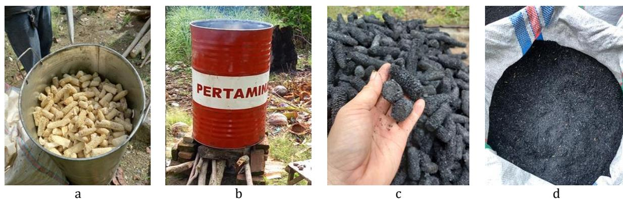
Gambar 5 Pembuatan biochar/pupuk api menggunakan drum bertingkat: a) Drum bagian dalam diisi tongkol jagung, b) Pembakaran dengan suhu mencapai 300°C pada drum luar, c) Biochar tongkol jagung, dan d) Biochar sekam padi.
