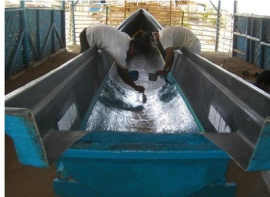
Gambar 4 Pelapisan *gelcoat*
